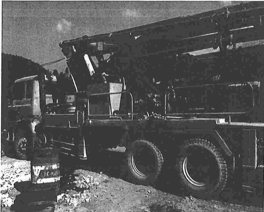
Xe bơm bê tông, Công suất 80 – 100 m 3 /h
